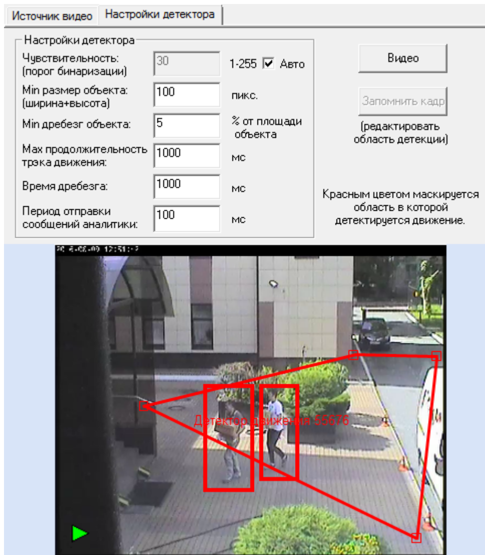
Рисунок 3 — Частные свойства элемента Детектор движения , вкладка Настройки детектора
