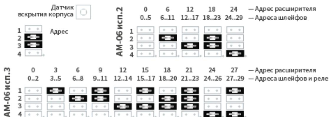
Например, если установлены перемычки 2 и 3:
