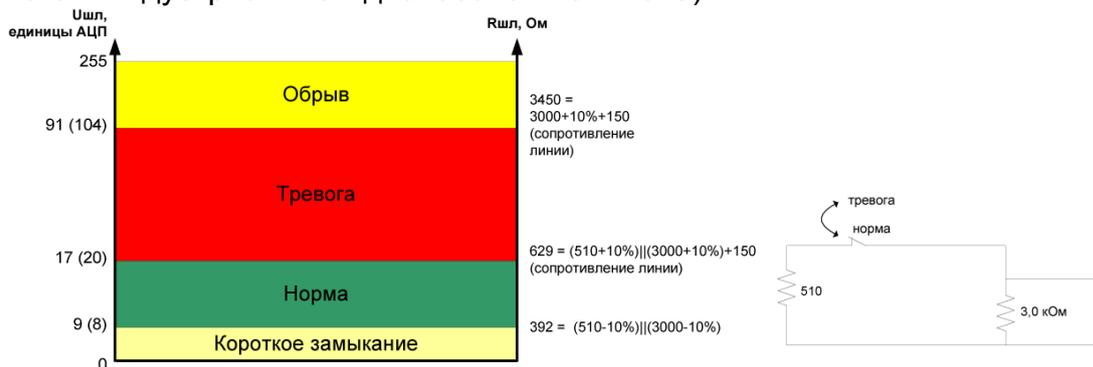
Диаграмма порогов состояний шлейфов БОРЕЙ без контроля цепи нагрузки (работа в режиме сухого контакта, при этом в качестве порогов состояний «замкнуто» [Норма] и «разомкнуто» [Тревога] используются границы состояний [Короткое замыкание] + [Норма] и [Тревога] + [Обрыв] соответственно):
