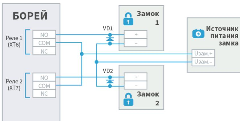
При организации двусторонней точки доступа, замковое устройство подключается к выходу Реле 1 (XT6). При организации двух односторонних точек доступа возможно использование замковых устройств разных типов. Для электромеханических замков диоды VD1, VD2 устанавливаются в непосредственной близости от замка; тип диодов 1N4007 или аналог.
