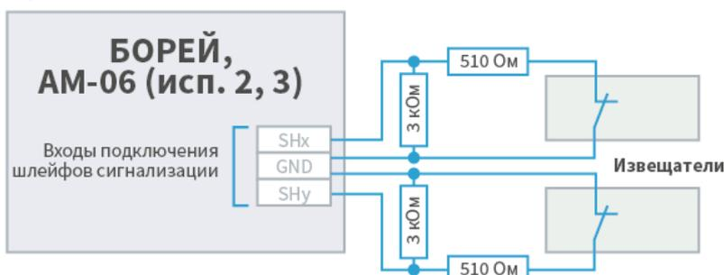
Тип контактов извещателя (нормально замкнут или нормально разомкнут) указывается в веб-интерфейсе. Резисторы устанавливаются в непосредственной близости от извещателей.
