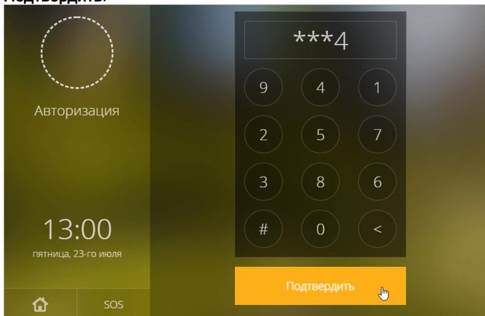
✔ Во избежание считывания следов пальцев с экрана планшета, используется интерактивная скремблированная клавиатура — расположение цифр на клавиатуре каждый раз меняется.
